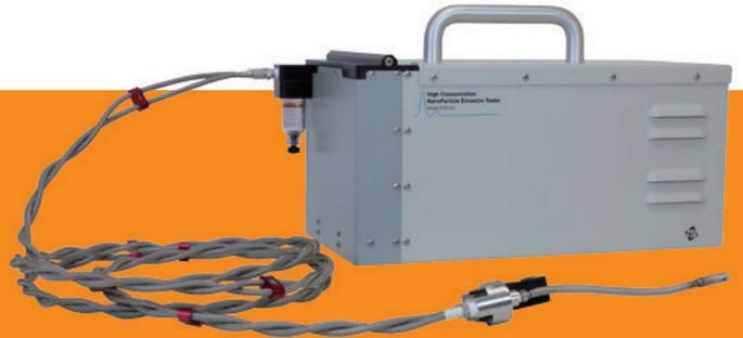
高浓度 NPET 源于 3795 型 NPET 的基本功能和独特设计, 让您将实验室级粒子计数带到您的工作现场。仪器与认证测试中使用的仪器设计类似, 内置的催化汽提塔可去除挥发性颗粒物, 仅用于测量总固体颗粒物排放量。
