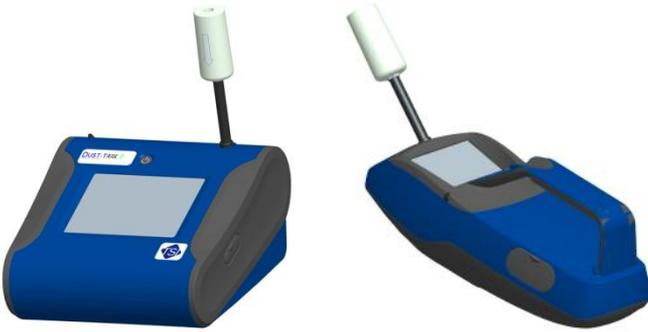
图 4-1: 在进样口上安装调零过滤器
